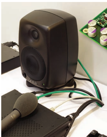
Акустические AoIP-мониторы GENELEC подключены по витой паре к сетевому коммутатору
